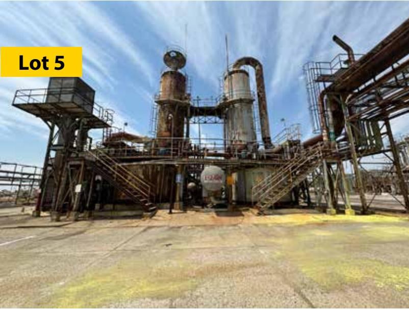
Planta industrial completa para proceso químico de obtención de BISULFITO Los equipos que incluye este proceso son: 4 Soplador de aire movido por motor eléctrico \*1 Quemador de Azufre \*Caldera para vapor a alta presión de 32 Kg/cm<sup>2</sup> \*3 Columnas de absorción \*5 Tanques (2 con agitación y 3 sin agitación) \*3 Enfriadores \*1 Tanque de Almacenaje.
